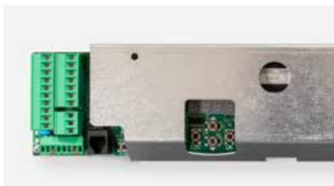
Unità di controllo dotata di connettori e morsetti estraibili
