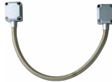
PASSACAVO IN ACCIAIO INOX PER AUTOMAZIONE E PORTE. DIAMETRO INTERNO 9MM LUNGHEZZA 45CM
