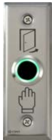
PULSANTE A SFIORAMENTO INFRAROSSO PORTATA DA 4 A 15CM DA INCASSO REGOLAZIONE TEMPO IMPULSO DA 1 A 30SEC
