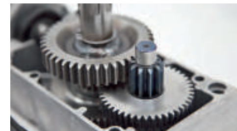
Ingranaggi completamente metallici
