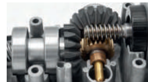
Riduzione completamente metallica
