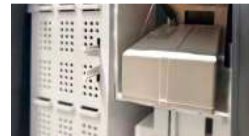
Batterie tampone da 2Ah (opzionali)
